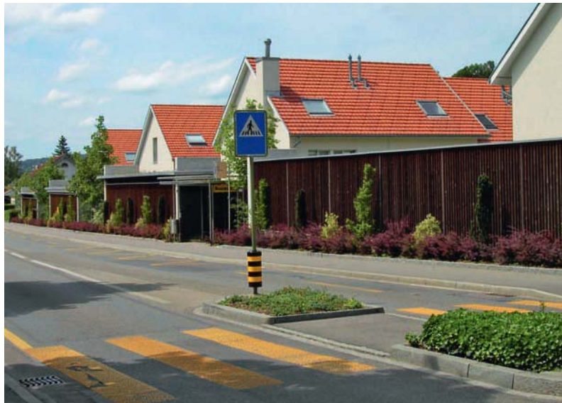
Attraktive Lärmschutzwand als integrierter Bestandteil einer Überbauung.
